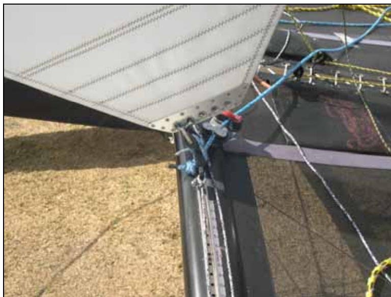
Controllo della messa a punto dell'angolo di bugna del fiocco
