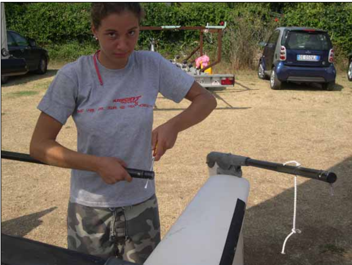
Modifica della barra telescopica per una corretta messa a punto della convergenza dei timoni
