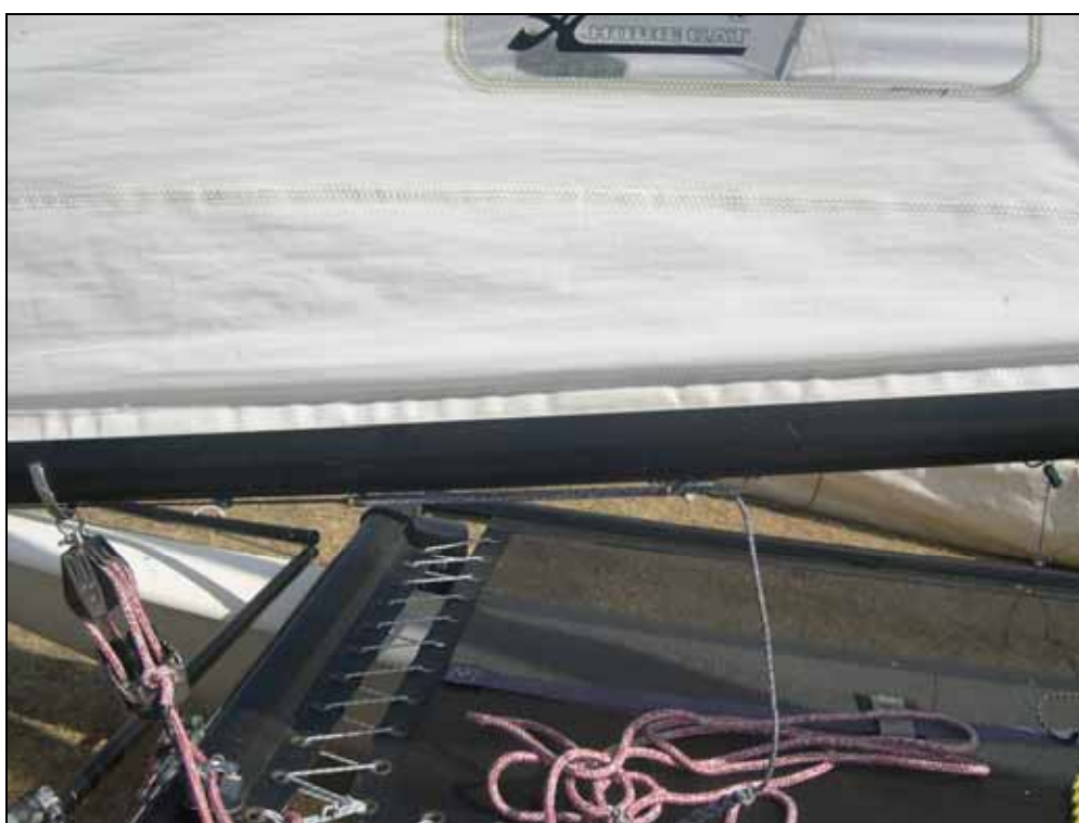
Controllo della distanza dei bozzelli della randa per una corretta regolazione dell'appoggaggio dell'albero
