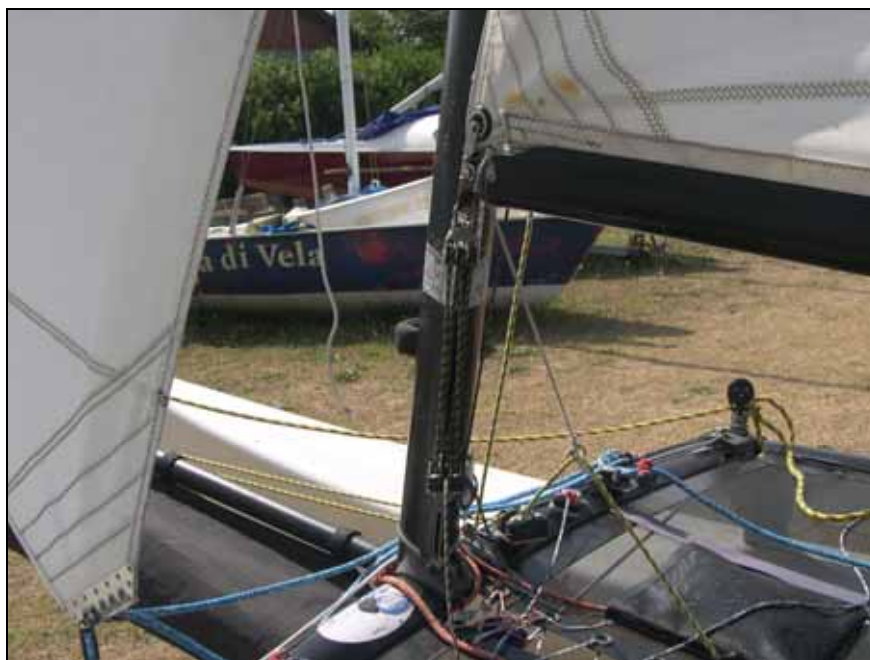
Particolare del paranco del nuovo sistema di caricabasso della Randa.
