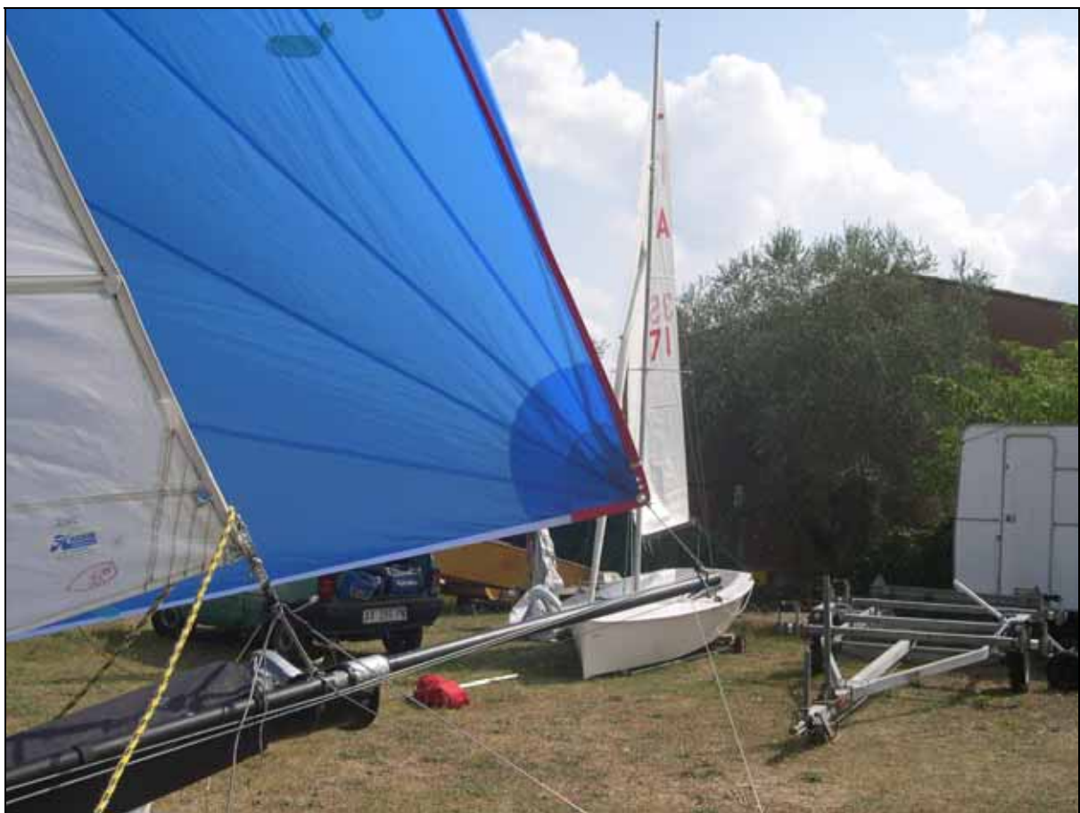
Particolare dell'angolo di mura del gennaker issato, con la specifica della mura distante dal bompresso
